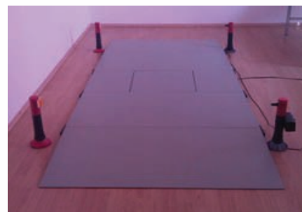
Fig. 107. Sistem de masurare a vitezei pentru platforma de masurare a reactiunii solului
