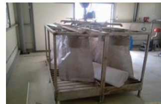
Fig. 46. Sistem de deshidratare a namolului în saci și hidrociclon
